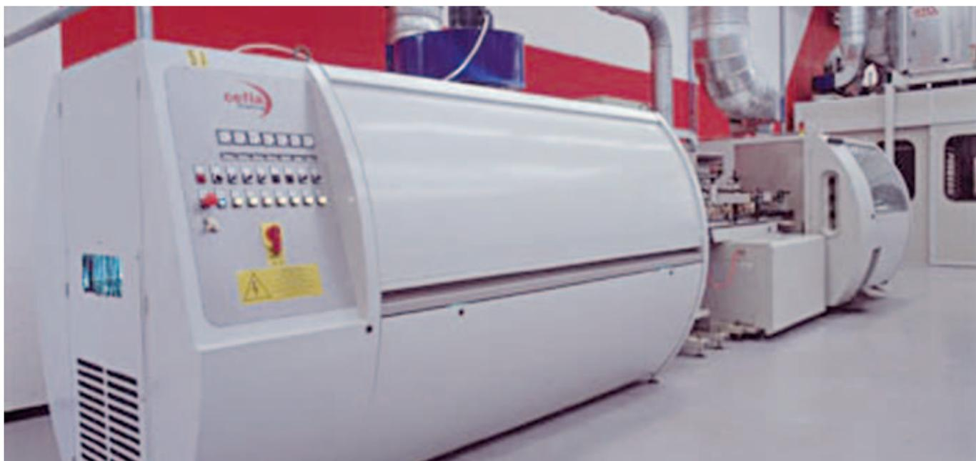
Forno a lampade UV ad alta pressione per la reticolazione delle vernici fotosensibili.
