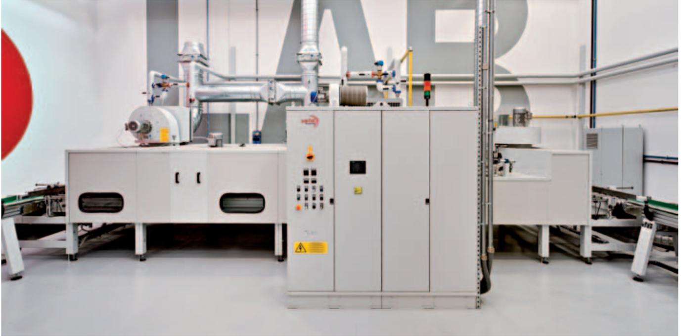
CROSS OVEN è un forno trasversale che consente l'essiccazione di tinte a base acqua ed a base solvente, e l'appassimento e/o l'essiccazione di vernici a base acqua e base solvente.
